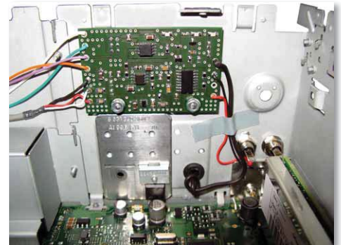
Umbau eines RCD510: Die Zusatzplatine befindet sich an der Rückwand, rechts hinten sitzen die neuen Cinchbuchsen
